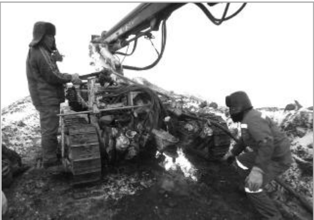
▲近日，冒着零下 20 度的低温，土木公司新疆项目员工在大雪封山之前，通过一步一火烤的方式，耗时四小时将因结冰而动弹不得的钻机开下 400 米“天路”。图为项目员工正通过火烤方式护送钻机下山。慕雷雷 / 摄
